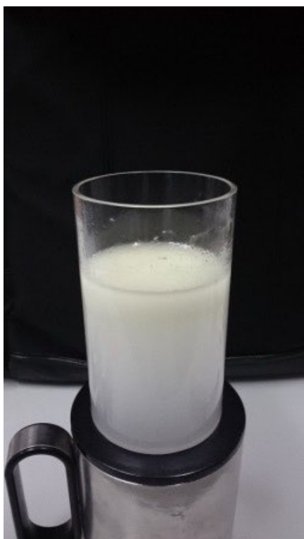
写真 NO3 発生器を10分再稼働し10分静止した後の状態——乳化 撮影4月5日
