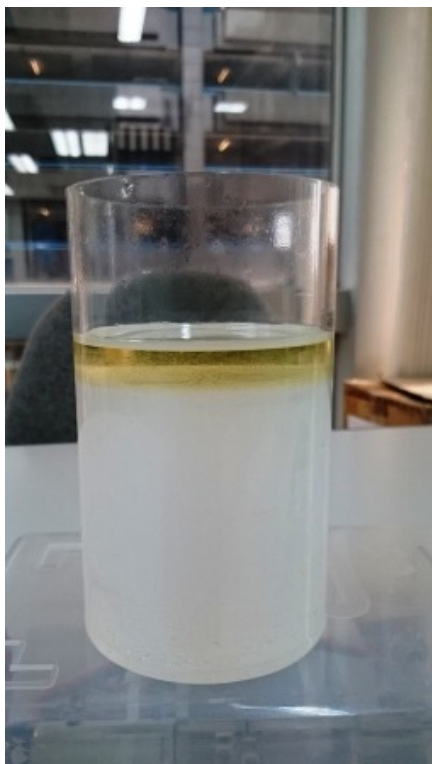
写真 NO4 発生器を再度10分稼働し、24時間後放置した状態のもの— 2層分離 撮影4月6日
