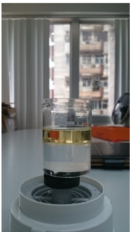
写真 NO5 上記の実験で発生した分離状態したサンプル液実験後2週間放置したもの— 3層分離 4月19日撮影
